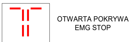
Rys.4 Otwarta pokrywa miodarki, naciśnięto przycisk EMG STOP
